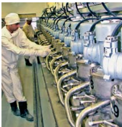
Каскад центробежных экстракторов
