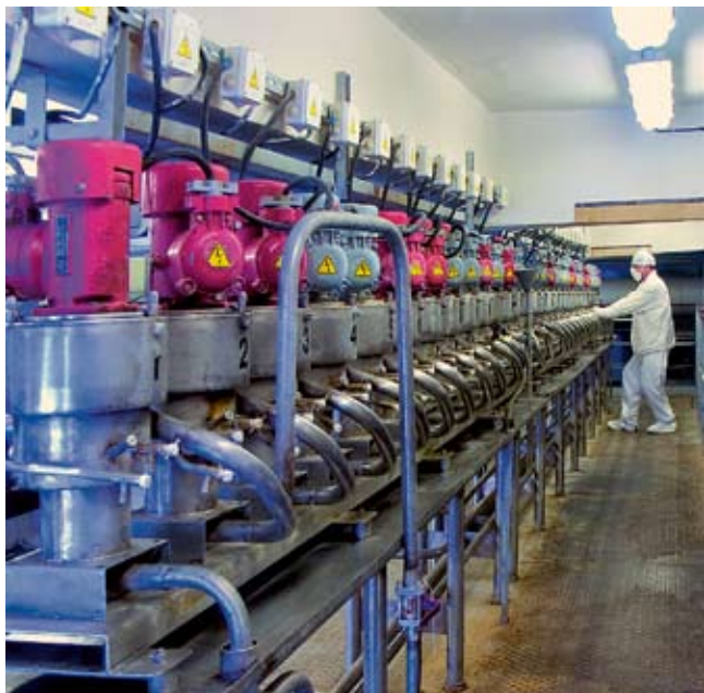
Каскад центробежных экстракторов
